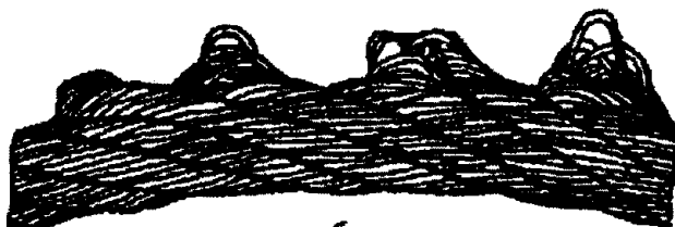
Рисунок 12. Выдавливание проволок прядей:
