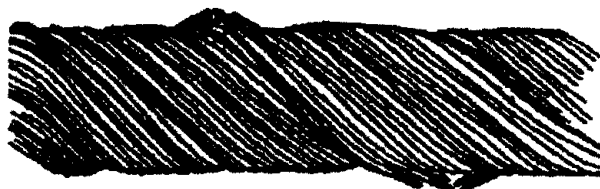
Рисунок 2. Сочетание обрывов проволок с их износом:
