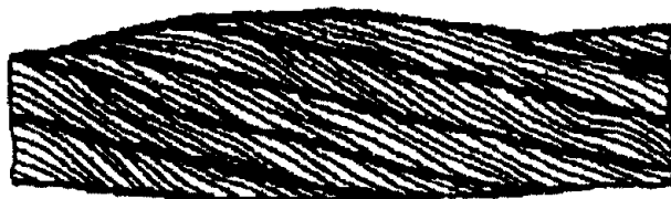
Рисунок 13. Местное увеличение диаметра каната.
