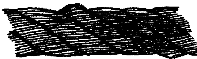
Рисунок 1. Обрывы и смещения проволок каната крестовой свивки.
